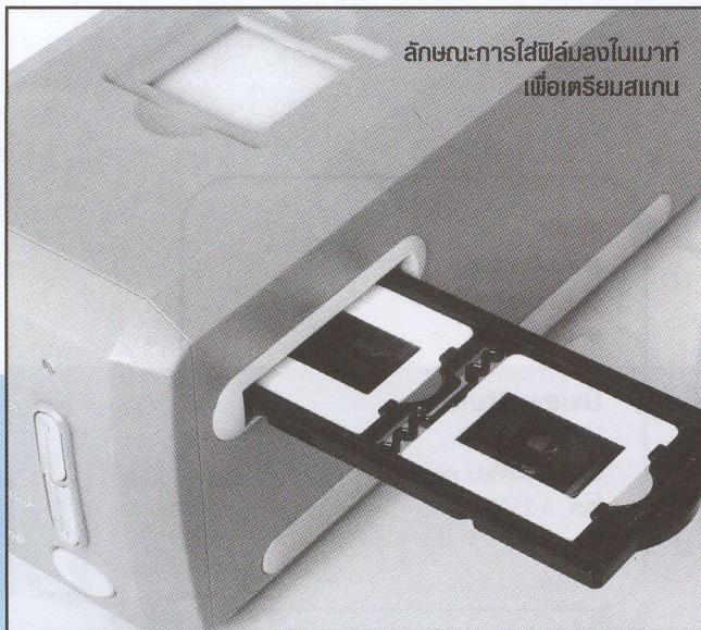
ส่วนการเข้ามือต่อกับเครื่องคอมพิวเตอร์นั้นจะใช้พอร์ตความเร็วสูงอย่าง USB 2.0 ซึ่งทำการทดสอบแม้จะเป็นการสแกนที่ความละเอียดสูงระดับ 1,800 dpi ขึ้นไปใช้เวลาไม่ถึง 30 วินาทีก็สามารถสแกนได้เรียบร้อย
