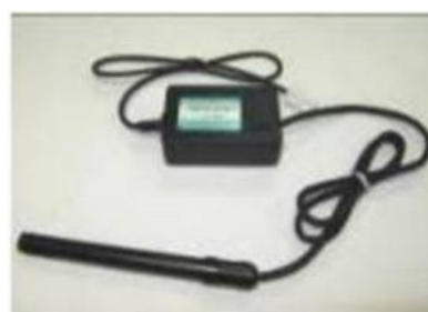
เครื่องวัดสารละลายที่มีเกลือเป็นส่วนประกอบ
